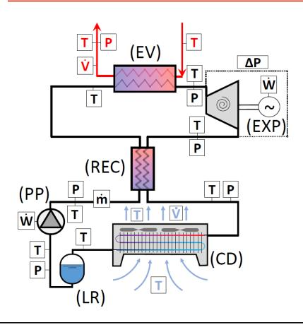
**P** : pressure sensor - **T** : thermocouple -  $\dot{m}$  : mass flow meter  $\dot{V}$ : power meter -  $\dot{V}$  : volumetric flow meter
